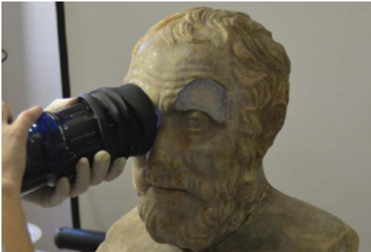
Durante il restauro, Erma del filosofo Carneade, analisi della superficie marmorea attraverso la microscopia ottica digitale
