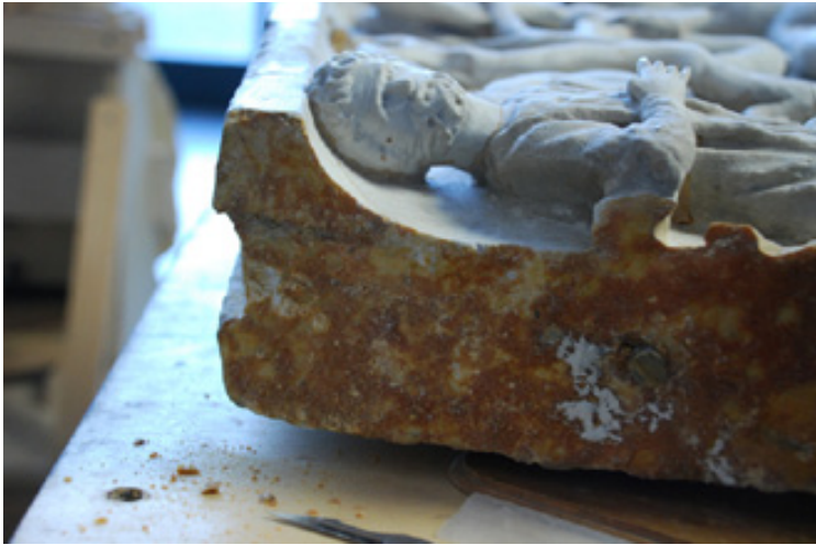
Durante il restauro, particolare del frammento destro del sarcofago dopo il distacco: superficie della lesione con il perno in ottone segato
