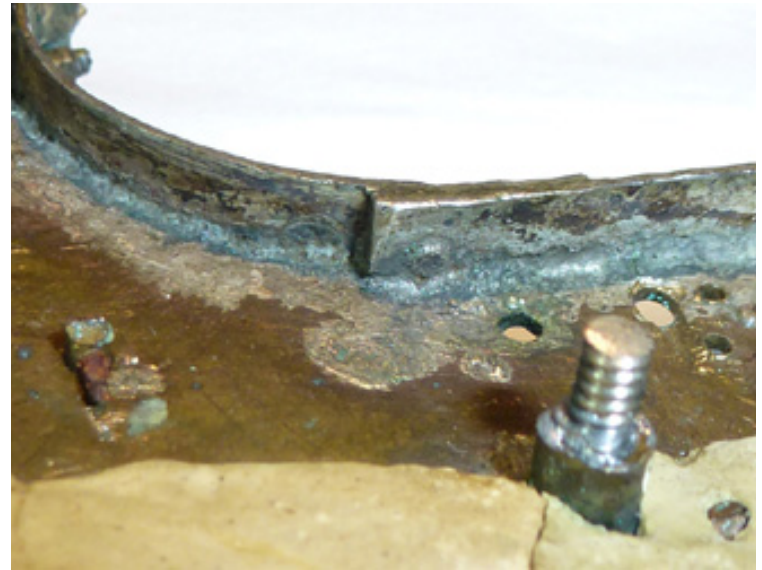
Durante il restauro, fronte, particolare dell'interno; saldatura del bordo alla lastra di rame, in primo piano il materiale 'gessoso' ed uno dei perni filettati dell'ultimo assemblaggio, sulla sinistra un pernetto in ferro
